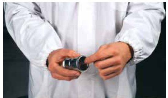
Fig. 30 - Kontrol af O-ring
