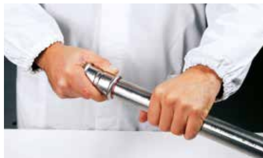
Fig. 31 - Indføring af rør i presfitting
